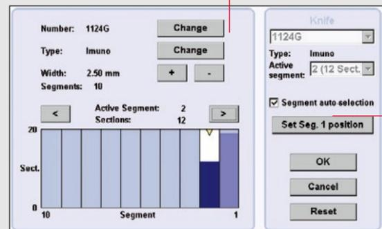
为优化钻石刀的使用，最多可存储 100 组不同钻石刀参数。每把刀被分成一定数量的刀刃片段，可选定刃口片段，马达驱动刀台自动完成对刀工作（Leica 专利设计）。
