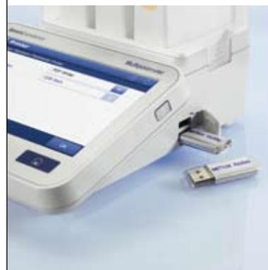
仪表支持将测量结果以PDF格式导出到U盘，因此用户在记录结果时，可以将数据打印到梅特勒-托利多或网络打印机，也可以选择把数据导出到U盘。这对于无纸化办公的实验室特别有用。
