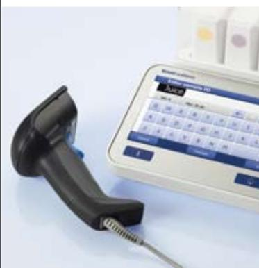
仪表的触摸屏操作能够实现快捷方便地输入文本，如样品ID。您还可以使用USB条形码扫描仪或USB键盘进一步提高效率。
