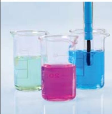
运用方法可安全有效地校准pH电极。方法创建后，每次校准都将使用相同的设置。可以监测零电位和斜率的限值，以避免存储不良校准结果。
