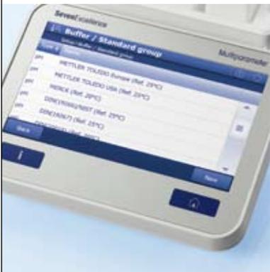
可从八种预定义校准缓冲液组中选择一组，或者自己轻松地创建。借助Pick-and-Mix™功能，您可以将不同组别的pH缓冲液组合起来。在校准之后，电极图标使您对校准结果一目了然。
