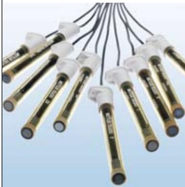
SevenExcellence™可以连接perfectION™系列复合离子选择性电极以及半电池电极系列。如果使用半电池电极进行测量，需要连接参比电极。
