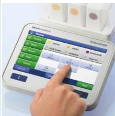
您只需一键点击快捷方式就能启动方法：一系列分析步骤和固定的预设参数。使用方法确保您始终执行相同设置的特定分析。
