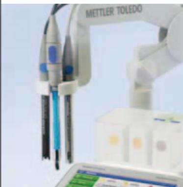
无论是相同或是不一样的样品，SevenExcellence™允许同时测量1个、2个或3个参数。对于相同样品的多参数测量，您可以选择指定所有模块使用的温度信号。
