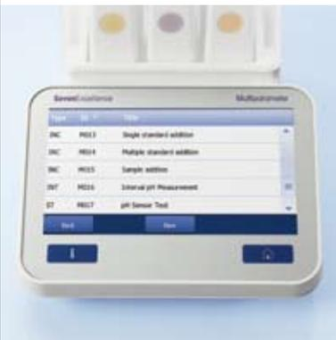
SevenExcellence™内置采用增量离子测量技术的特别方法，如标准品增量/减量法和样品增量/减量法。您可以从此获得一个灵活和现代的工具包，实现专业的离子测量！
