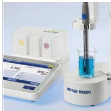
梅特勒-托利多的uMix™磁力搅拌器为方法增加额外的灵活性。可以为您的方法的测量或等候步骤单独设置搅拌，并可根据样品的容器大小或粘性调节搅拌速度。
