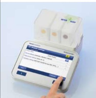
仪表提供多个级别的校准支持，固定的校准顺序、通过可选剔除自动评估校准结果、以及监控电极的寿命和校准间隔都突出了方法的特性。还可以通过Rondolino自动进样器实现自动校准!
