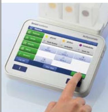
该仪表有第二种启动测量或校准的方式，按READ键或CAL键即可开始进行测量或校准。虽然更加灵活，但连续执行对不同参数的直接测量需要在准备每个样品之前更改设置。
