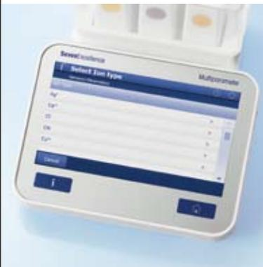
十二个最常用的离子类型已预先编程在仪表中，使设置非常方便。对于其它电极，您可以输入离子价态和摩尔质量，以确保所有的计算和交换为您量身打造。
