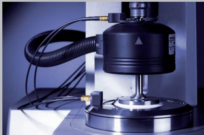
带平行板测量系统的帕尔贴温控介电流变设备
