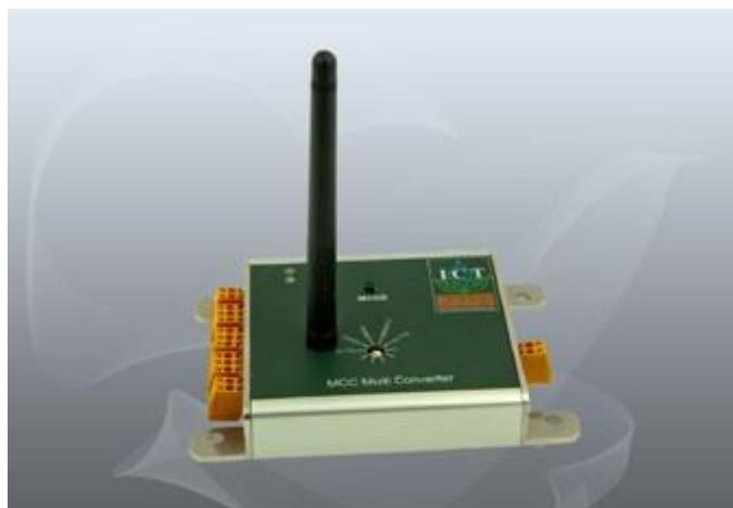
MCC2 无线数据采集设备
