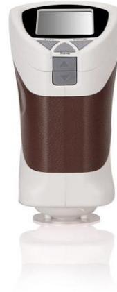
广泛应用于塑胶、印刷、油漆油墨、纺织、印染服装等行业的颜色管理领域，根据 CIE 色空间测量样品色值  $L^*a^*b$ 、 $L^*c^*h$ ，与被测样品的色差  $\Delta E$  以及  $\Delta Lab$  值。
