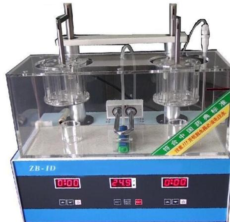
ZB-1D 智能崩解仪是根据《中国药典》有关片剂、胶囊剂、丸剂等崩解时限检测的规定而研制的机电一体化药检仪器。其主要技术指标也符合 USP、BP 关于崩解时限检测的规定。
