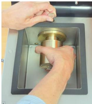
用封口按钮扣止动销安装检测轴承体
