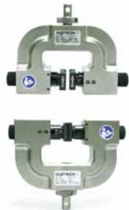
2 kN 手动螺旋夹具
