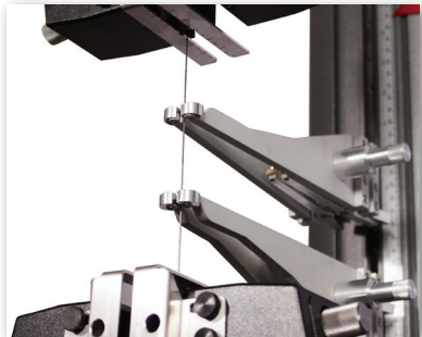
使用 AutoX750 对气动平推夹具中的碳纤维进行拉伸试验
