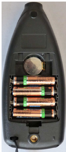
碱性电池供电
