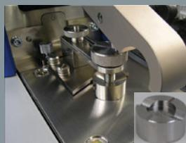
1-3mm直径线材样品和薄片样品夹具
