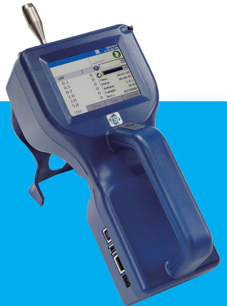
TSI 公司 9306 型手持式粒子计数器多功能灵活性等特点为手持式粒子污染监测提供了条件。9306 型配备了符合人体工程学的手柄与拇指控制，便于单手操作。8.9cm 的彩色触摸屏界面使其方便设置和操作。9306 型可以生成 ISO 14644-1, EU GMP Annex 1, and FS209E 的通过或非符合报告。同时该仪器内存可以储存超过 10000 个样品记录，可以通过屏幕方便地浏览记录，使用 TrakPro™ 软件下载，或者使用外置打印机直接打印。
