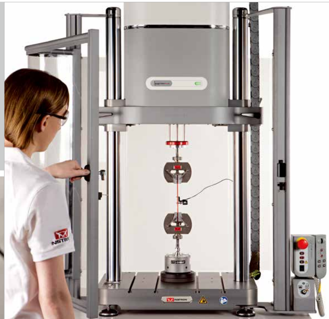
安全第一：E3000系统配有CE认证的安全罩和机械楔形夹具。
