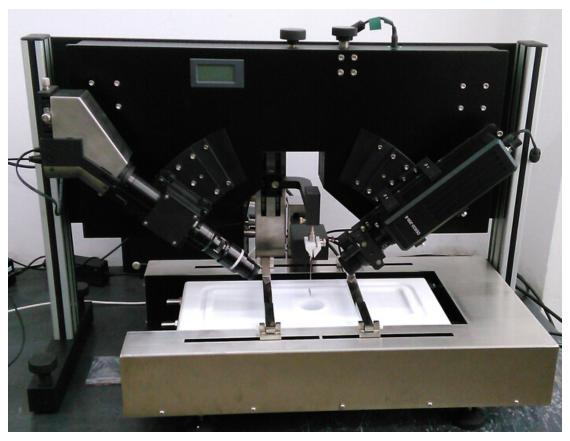
产品详细介绍: 多功能拉膜装置是测定极性有机物(两亲分子)物理化学特性的精密测量仪器。LB膜 分析仪在应用化学、生物膜、脂质体、集成光学、非线性物理、光电学、稀释活性源、LB 膜、超分子构型 等领域都有广泛的用途。
