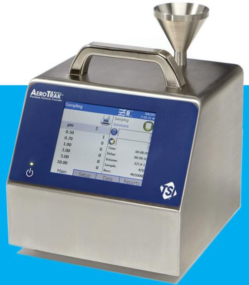
TSI 公司 9500 型便携式粒子计数器性具有一流的功能和特性。它完全遵从 ISO 14644-1 标准，根据欧盟的 GMP 标准 1 立方米的采样量，短短 10 分钟就可以完成。9500 型计数器与 TSI 精确的通风探头相兼容，这些探头可以测量风速 / 温度 / 湿度，为认证提供了一个完整的解决方案。配上一个管路长达 8 米的电子过滤扫描探头，成为现场过滤测试的最佳选择。
