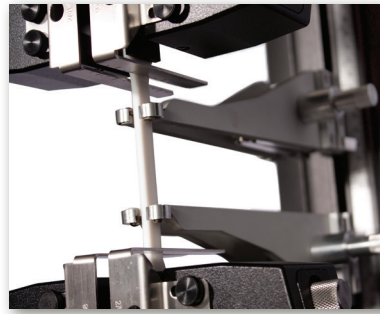
在电子万能试验机上使用 AutoX750 进行塑料拉伸试验
