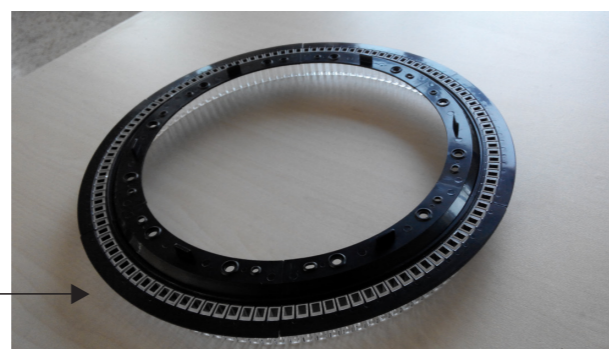
AutoChem 2100采用6mm光程高精度光学反应管，反应完成后直接比色
