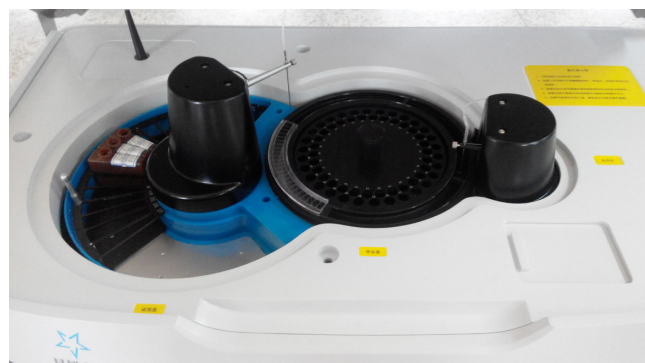
AutoChem1200工作台，左侧取样臂用来吸取样品和试剂加入反应管中反应，右侧取样臂用来从反应管中将反应后的样品吸入流通池检测。
