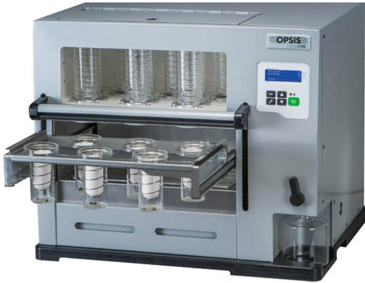
通过改进的溶剂抽提方法，可以快速的从固体混合物或半固体物质中分离一种或一类物质。可以测定饲料、食品、清洁剂、橡胶、塑料、聚合物、药品、石化产品、纤维制品、土壤、污泥等物质中的可溶性有机化合物（脂肪、表面活性剂、农药等）。
