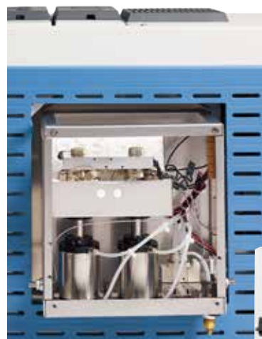
紧凑型辅助阀箱安装于 TRACE 1300E GC 系统的右侧
