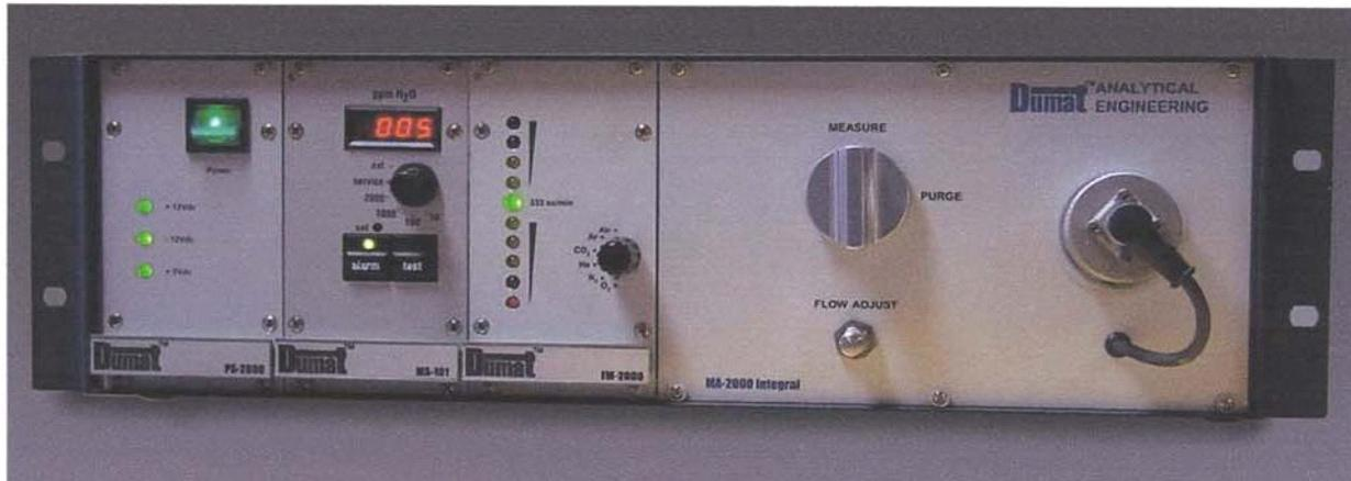
**MA-2000-integral 型微量水分析仪**连续自动测量水含量，检测上限为 2000ppm。该分析仪在气体生产工艺监测过程中有很广泛的使用。
