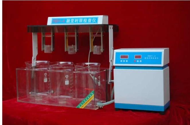
RBY-4 型自动融变时限检查仪，是根据《中华人民共和国药典》中关于“栓剂融变时限检查法”的要求而设计生产的机电一体化产品，用于栓剂及阴道片等固体制剂在规定条件下的融化、软化或溶散情况的检查。RBY-4 型自动融变时限检查仪采用单片机控制恒温水浴，具有精确时限控制、计时报警及实验金属架按时自动翻转等功能，操作简单，性能优良，完全符合药典的规定。
