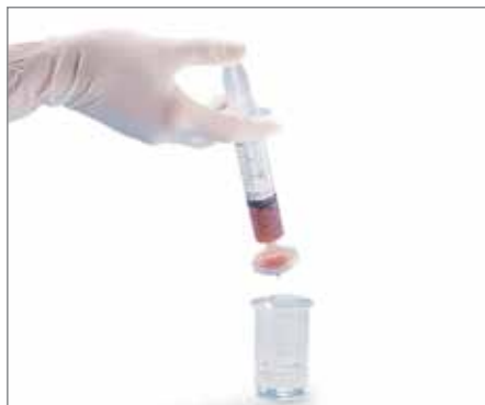
图 5. Sartobind MAs 既可以手动也可通过 Luer 接头连接层析系统使用。
