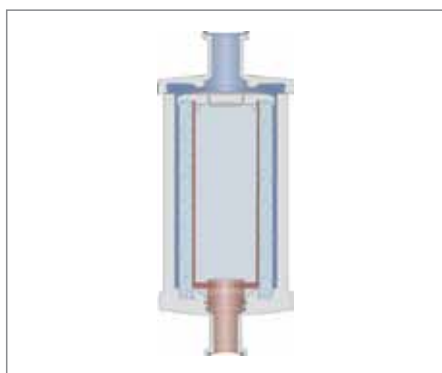
图 12. Sartobind 150 mL 囊式吸附器截面图显示细小的上游和下游通道。
