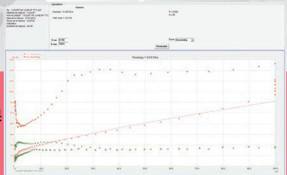
式转子，上升曲线反映了“凝胶化”的断裂，是非混合酸奶的特征，下降曲线利用的是13 Pa的YV和360mPa·s的塑性粘度，符合Casson型剪切稀化的特点，揭示了其在嘴里的变化。
