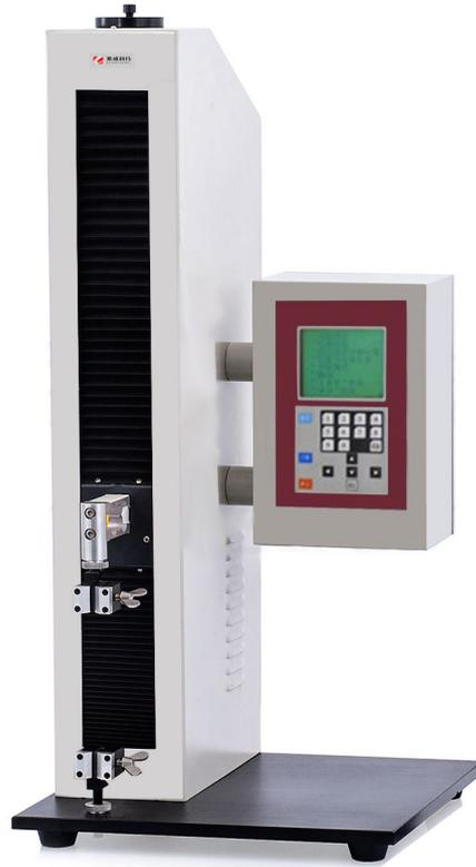
该设备适用于塑料薄膜、复合膜、软质包装材料、胶粘剂、胶粘带、不干胶、橡胶、纸张纤维等产品的拉伸、变形、剥离、撕裂、热封、粘合、穿刺力、开启力、拨开力、低速解卷力等性能测试。
