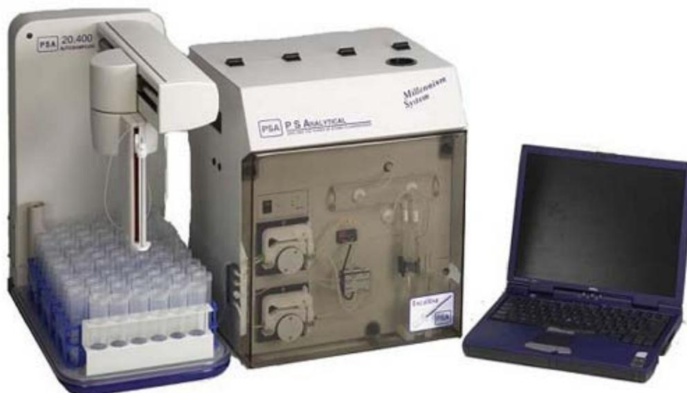
PSA 10.055 Excalibur AFS 自动化氢化发生原子荧光仪，用于测量痕量及超痕量的氢化发生元素及其形态分析。该系统的激发光源为可更换的高能量空心阴极灯，检测器为日盲光电倍增管，创新性的多级反射荧光过滤镜极大降低杂质元素的干扰，提高测定砷 As、硒 Se、锑 Sb、铋 Bi、碲 Te 的选择性。该
