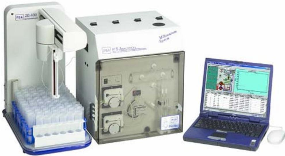
PSA10.025 Merlin AFS 自动化氢化发生原子荧光仪，用于测量痕量及超痕量的汞。该系统的激发光源为可更换的低压汞灯，检测器为日盲光电倍增管，创新性的多级反射荧光过滤镜极大降低杂质元素的干扰，提高测定汞的选择性。该系统可运行持续流动冷原子发生或断续流动冷原子发生。该系统提供强大的检出能力和分析效率，适用于日常常规分析及科学研究。
