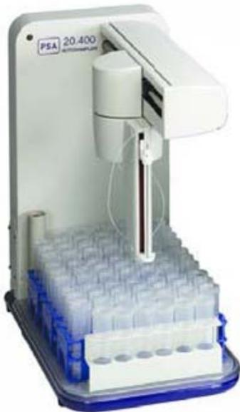
PSA 系列自动进样器一直以灵活使用作为其设计理念。P S Analytical 20.400 标准自动进样器（如下图所示）是连接 P S Analytical Millennium 系列原子荧光仪及快速高效样品分析的纽带。Millennium 软件 1.08 版本以上自动支持 PSA 20.400 自动进样器。该进样器包括 12 个标准样品槽（内径 29mm，50ml），以及三排样品架，可配置 120 支 15 毫升进样杯，或 75 支 50 毫升进样杯。不同大小尺寸的进样杯可供选择，请在订购产品时加以说明。
