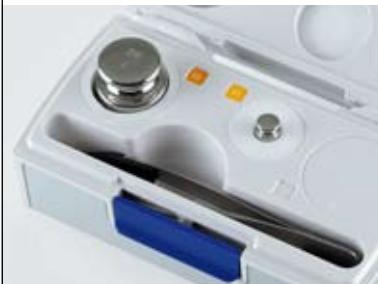
CarePac®包含遵从USP通则41需要测试天平的内容 — 对应天平量程5%和100%的两个测试砝码。专业的砝码操作包括镊子、手套和其他附件。
