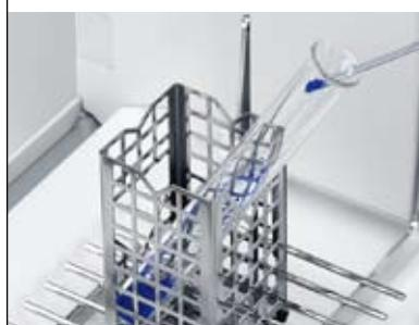
金属篮易巧称量件(ErgoClip)，具有法拉第笼效应，可避免天平吸附来自玻璃和塑料管上的任何静电荷。因此称量试管中的样品更为安全、可靠。
