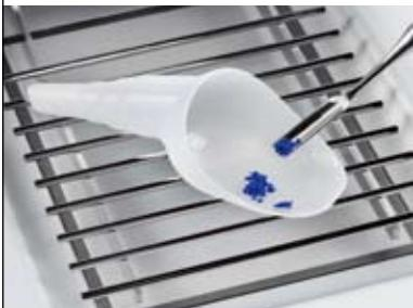
一次性称量漏斗(SmartPrep™)由抗静电材料组成，旨在简单、安全的粉末称量。独特的设计可轻松地加样，并可将粉末高效地冲洗到您所需要的容量内，从而最大限度降低样品损失。
