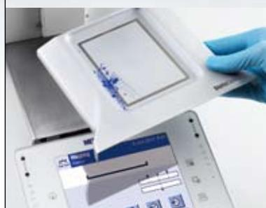
防风罩可在数秒钟内完全拆卸，且无需使用工具。网格秤盘(SmartGrid)下方的承水盘可收集所有溢液以便安全处置。所有部件均可在洗碗机中方便、彻底地清洁。
