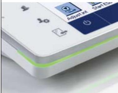
内置状态指示灯(StatusLight)通过颜色直观地显示天平的状态：绿色表示准备就绪，黄色表示警告，红色表示错误。StatusLight清晰地显示天平是否已准备好开始称量任务。
