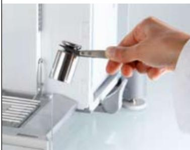
绝不会再次错过校准或日常测试。使用天平触摸屏，可在测试管理器(Test Manager™)内置固件中进行符合SOP的日常测试。无论何时进行测试，都会在屏幕上显示消息，您只需遵循随附的测试说明即可。
