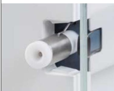
新的一体化去静电装置可用于生成离子电荷，在不产生称量室内的干扰的同时，消除静电荷。稳定的离子流防止样品交叉污染，并消除用户处理有毒物质时的威胁。
