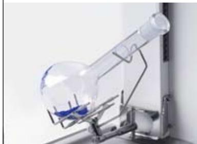
直接加样至去皮容器，避免了转移误差，最大限度地降低样品的损耗，从而节约了成本。即使形状特殊的去皮容器也可牢固放置。通过与最小称量防风门(MinWeigh™ Door)配合使用，ErgoClips可帮助您获得尽可能低的最小称量值。
