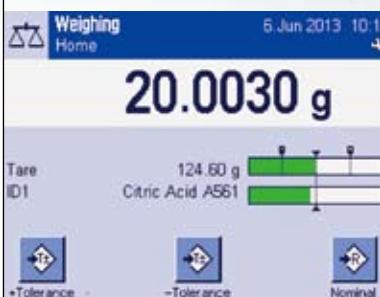
动态图形显示(SmartTrac™)功能使加样至目标质量变得容易并且符合允差范围。使用适当的易巧称量件(ErgoClip)可使您通过轻松的一步直接加样至容器中。
