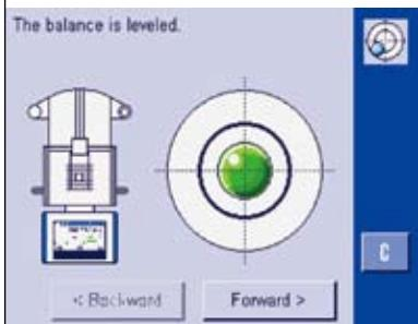
新的水平向导(LevelGuide™)会在天平未处于水平时提出警告。在触屏上显示完整的说明和图形化水平泡，这样您在数秒内便可调平天平。
