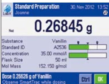
LabX在天平触摸屏上提供一步步的用户向导，从而确保精确地遵循SOP。集中式仪器管理意味着所有的天平都自动显示相同的SOP说明，以保证实验室获得一致性结果。
