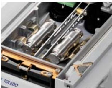
采用高分辨率后置式传感器，内置两组校正砝码，确保准确的称量结果。
