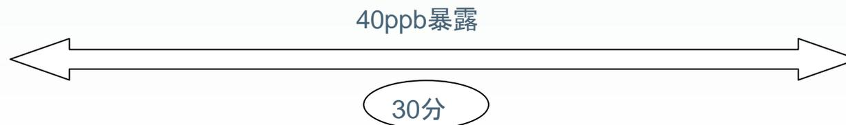
因为是脱离本体进行的测定，所以测定后换算浓度的时候，必须输入正确的测定时间和环境温度。显示和保存的浓度，要换算成30分钟的平均值。
