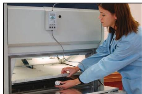
CR20 的 UV 传感器放置在样品架的校准端口内。
