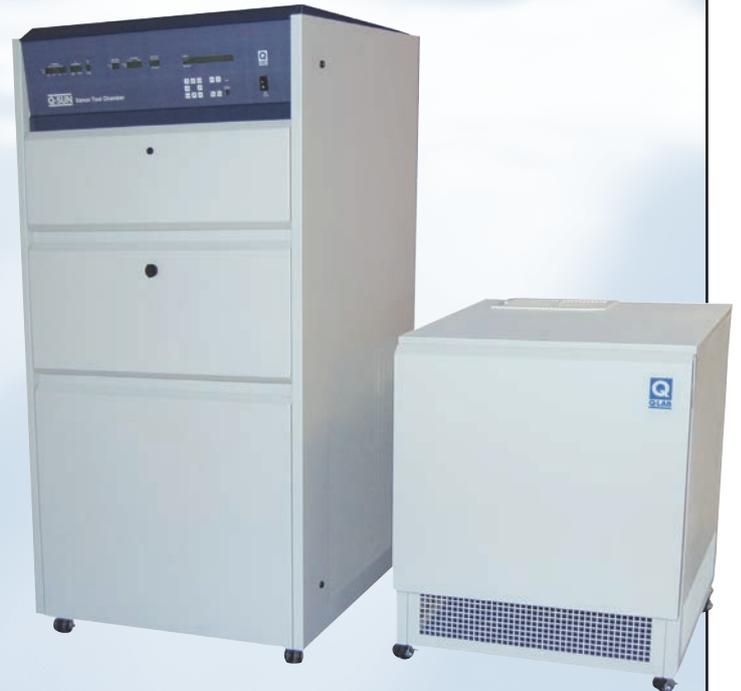
Q-Sun Xe-3 型号的制冷机是与主机并排安装的一个分离部件。Xe-1 型号的制冷机作为主机的基座。
