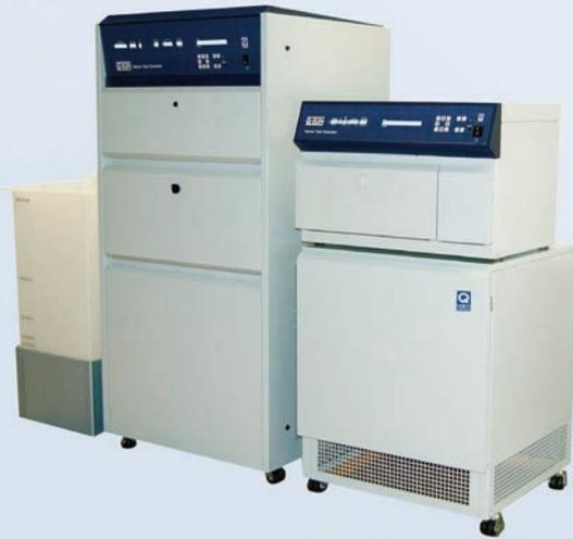
Q-Sun Xe-3型的大样品室几乎是Xe-1型样品室的4倍。图中Xe-3型配有双喷淋储罐；图中选配的制冷机作为Xe-1型台式机的基座。
