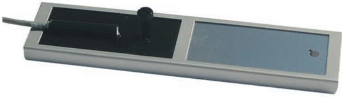
黑板温度传感器安装在2x4"样品夹上。
