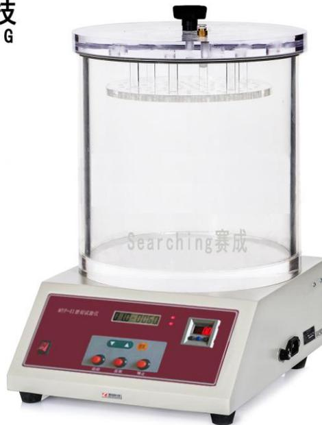
该设备适用于食品、制药、日化等行业软包装件的密封试验。亦可进行经跌落、耐压试验后的试件的密封性能测试。
