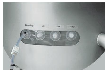
可提供 3 叶斜角搅拌桨和 6 叶直角搅拌桨。CultiBag STR 内整合了传统的环状气体分布器或气体微分布器。浸管使进料更加缓和,无剪切力。此外,培养袋还设有各种端口,以进行进料、接种、收获和取样等操作。为进一步的安全需求,培养袋还可以连接备用过滤器。
