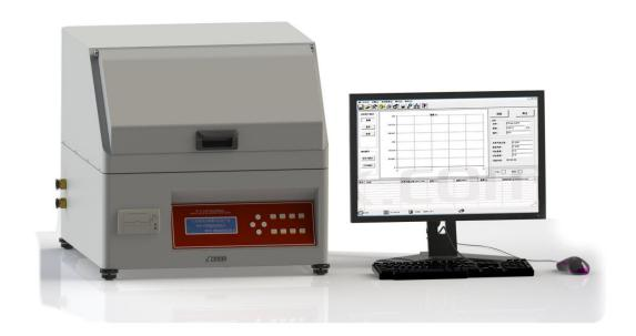
TSY-T3 水蒸气透过率测试仪 基于杯式法测试原理,是一款专业用于薄膜试样的水蒸气透过率测试仪,适 用于塑料薄膜、复合膜等膜、片状材料与医疗、建材领域等多种材料的水蒸气透过率的测定。通过水蒸气 透过率的测定,达到控制与调节材料的技术指标,满足产品应用的不同需求。
