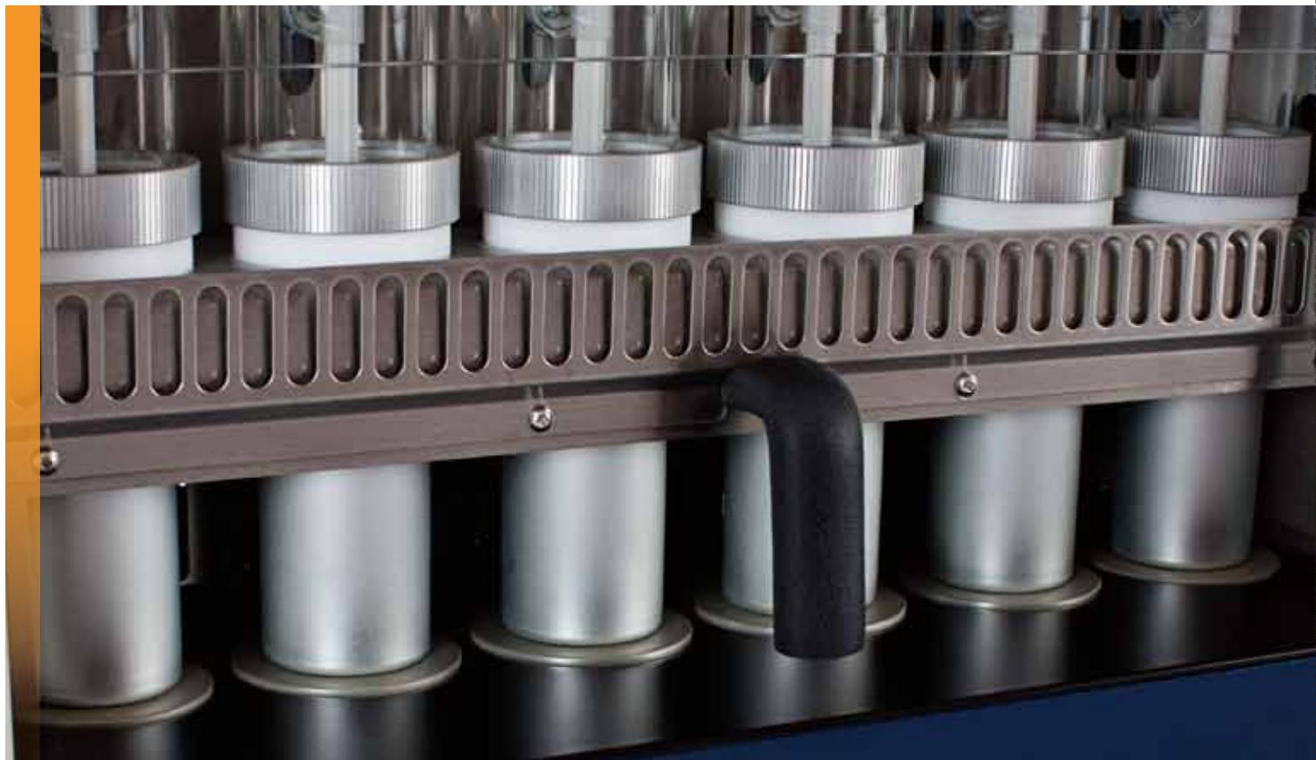
福斯总脂肪分析解决方案使总脂肪分析变得自动简单。整套系统包括一个抽提单元、一个水解单元和各单元共用的单个过滤系统。福斯的总脂肪解决方案可让您通过一个一体化的步骤来进行酸水解和溶剂抽提。该系统在降低总脂肪分析成本和提高样品处理量的同时可以减少潜在的人为误差。
