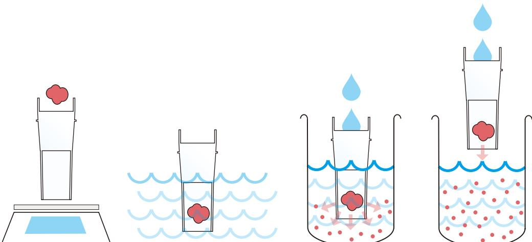
独特的专利HydroCap样品杯，从最初称量样品、整个水解过程直至最终抽提步骤都在其中完成，避免了样品转移的误差。这是个完全自动化的系统，可进行加酸、加热、沸腾、清洗和排废。
