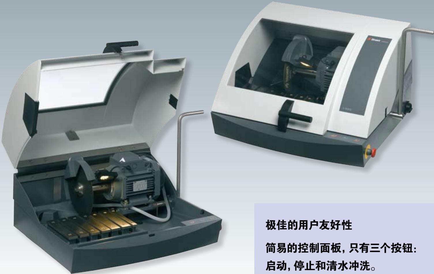
Labotom-5是一款高品质的带工作台的手动切割机，它采用250 mm/10”直径的切割砂轮。它主要针对在实验室和生产环境下的应用而设计。
