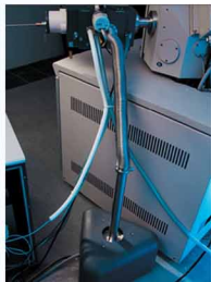
分立式涡轮泵抽真空系统
