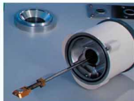
冷冻传输装置 - 带有样品梭及样品座
