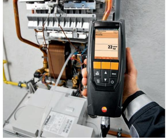
所需附件：软管连接组件，用于单独测量气体压力，
