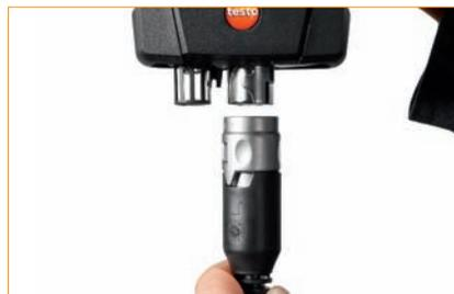
因此 testo 320 高效烟气分析仪可实现供暖系统的多种测量，不仅因为其丰富的测量菜单，还得益于它的探头理念。如果没有 testo 320 这些可用的探头，您可能就需要购置额外的仪器以完成相应的功能了。仪器革新化的探头接口，更换探头简单方便：单个卡口连接适于所有探头，也就是说通过这一个接口，一条气路，可将所有气路都连接至仪器。
