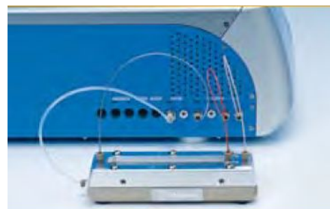
与 Eclipse 控制器底座相连的 Wyatt AF4 的其中一个分离通道。
