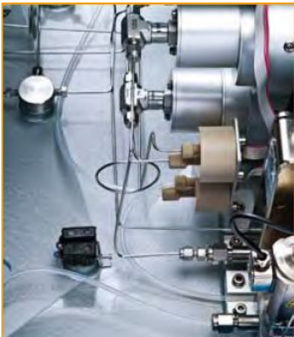
压力传感器，泄露传感器和防漏盘的细节图，有机相体系下使用的管路是不锈钢管。
