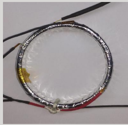
高效色谱柱柱上加热系统
