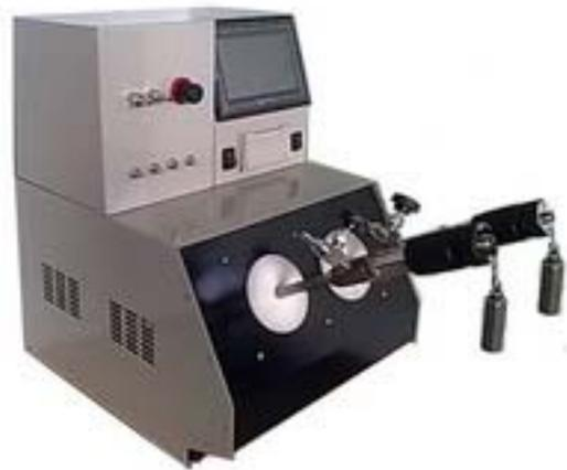
XF-2272 型旋转氧弹法氧化安定性试验仪为恒温+油浴计算机控制。
