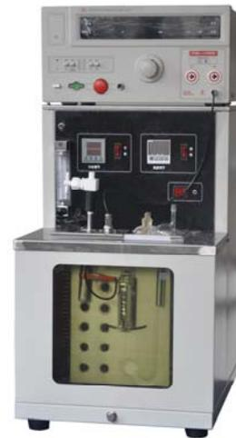
XF-11142 型绝缘油析气性能自动试验仪系本公司最新开发出来的高科技产品。主要用于检测绝缘油或绝缘液在受到强度足以引起在油、气交界处放电的电场（或电离）作用下，放出或吸收气体的倾向。仪器适合测定电缆油、电容器油和变压器油（矿物油或合成油）析气性能。
