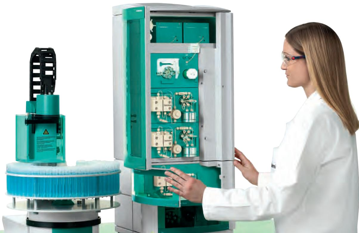
几乎所有的实际样品在进行分析之前均需要进行样品前处理。通过搭配不同类型的瑞士万通英蓝样品前处理模块《MISP》，940系列谱峰思维™离子色谱可实现不同样品的全自动在线前处理操作，例如超滤、稀释、渗析和预浓缩处理。
