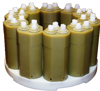
LVHP 消解罐装置
