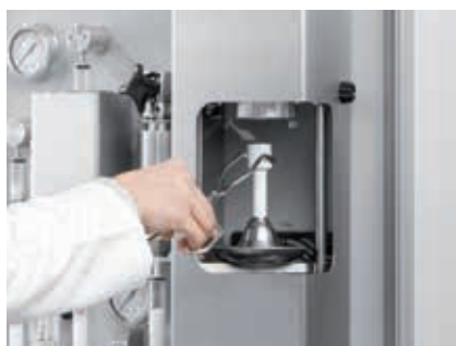
将样品放在托架上 也可选用自动进样装置
