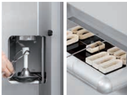
将样品放在高频感应炉 (左) 或电阻炉 (右)
