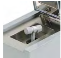
① μT-01安装微管的部分
