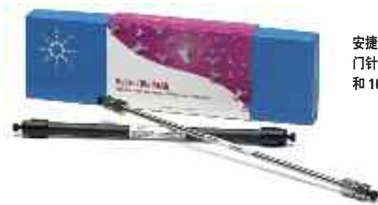
安捷伦 Bio MAb HPLC 色谱柱填充了一种独特的高分离度树脂填料, 专门针对单克隆抗体基于电荷的分离模式设计, 有 1.7 μm、3 μm、5 μm 和 10 μm 等各种规格, 由于粒径较小, 能够得到更高的分离度。
