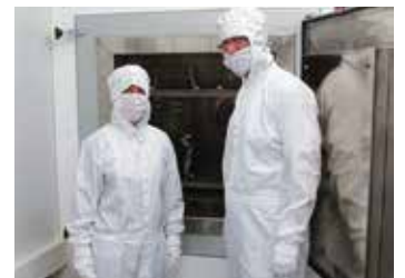
NAC 250/65 空气循环炉，级别为100的无菌室结构型式，炉门位于无菌室内
