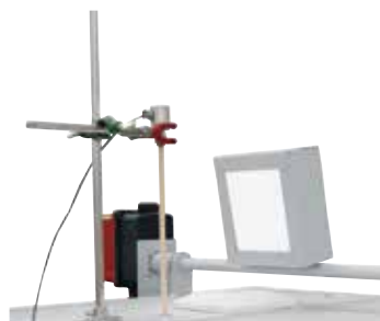
作为附加装备的排气门和带支架的炉料热电偶
