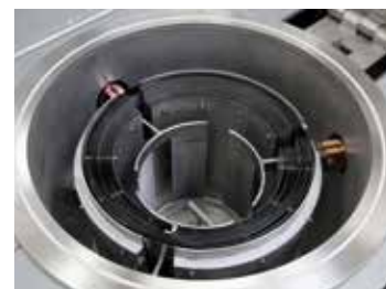
带钨丝加热装置的圆柱形气密罐
