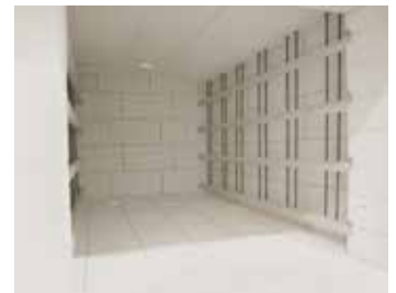
加热元件前的保护格栅防止机械损伤
