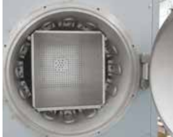
NRA ../06 炉型设有内置加热元件
