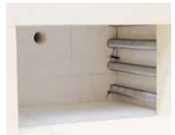
炉腔具备高级轻质耐火砖保温结构
