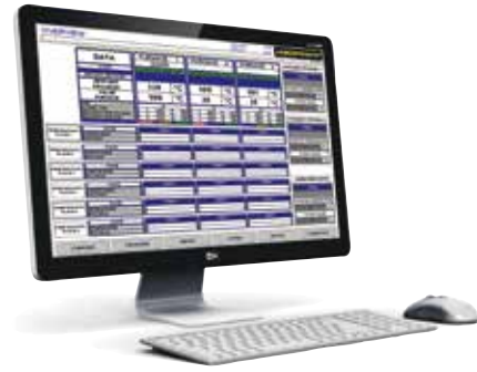
Controltherm MV 软件用于控制、可视化和记录
