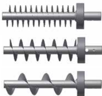
带不同坡度的螺旋输送机，用于调节输送量
