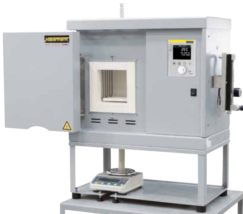
LHT 04/16 SW炉型带用于确定燃烧失重的称量装置和供气系统
