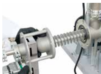
转速可调节式螺旋输送机
