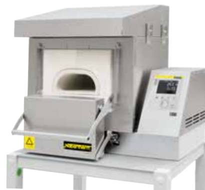
N 4/13 CUP 作为实验室灰吹炉
