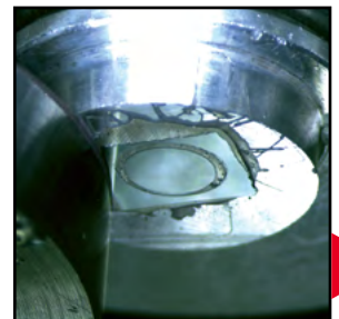
将制备好的样品第一面粘在铣平了的铝台上。对第二面进行切割、研磨抛光。
