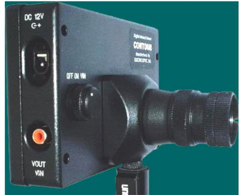
CCD 探头，集成 4 英寸薄膜液晶显示器。设计轻巧紧凑，可方便手持，并配有 1/4-20 内螺纹用于安装接杆。
