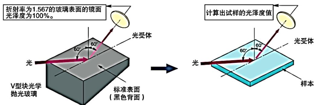
光泽度计的测量原理如上图所示。仪器的测量由发射器和接受器组成，发射器由光源和一组透镜组成，它产生一定要求的入射光束。接受器由透镜和光敏元件组成，用于接受从样品表面反射回来的锥体光束。参照标准是折射率 1.567 的黑玻璃，并定义此时的光泽度值为 100 光泽单位，如上图所示。
