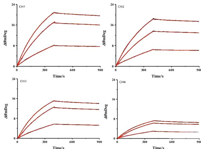
四个分析通道获得的不同浓度的结合曲线经扣除参比通道的背景并模拟后得到的结合速率常数 $k_a$ 为  $8.6 \times 10^4 \pm 0.5 \text{ M}^{-1}\text{s}^{-1}$  解离速率常数 $k_d$ 为  $1.5 \times 10^{-4} \text{ s}^{-1} \pm 0.25$  以及结合常数 $K_D$ 为  $1.7 \text{ nM} \pm 0.2$
