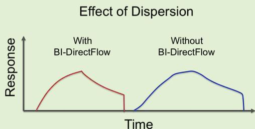
左图显示的结合信号由于没有扩散而具备清晰明了的结合和解离区间，可提供精确的结果。右图显示的信号由于有扩散结合和解离区间模糊难辨，获取的结果不可靠。
