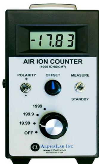
空气负离子浓度仪是吸引空气（或者带有离子存在的气体）通过带电的平行极化电极板进行计数空气中的正、负离子（气体）浓度的，外侧二板保持极化（正、负）电势。中间是线性检测器板。空气的孔隙是 4MM，极化区的电势是 1000V/M。既可测定正离子，又可测定负离子。也可测定有关机体的负离子浓度，如环境、固体物质（石头和灰）、布匹、纤维等。
